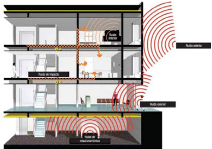
Figura 39. Fuentes de transmisión de ruido a considerar para definir la distribución interior de espacios.
